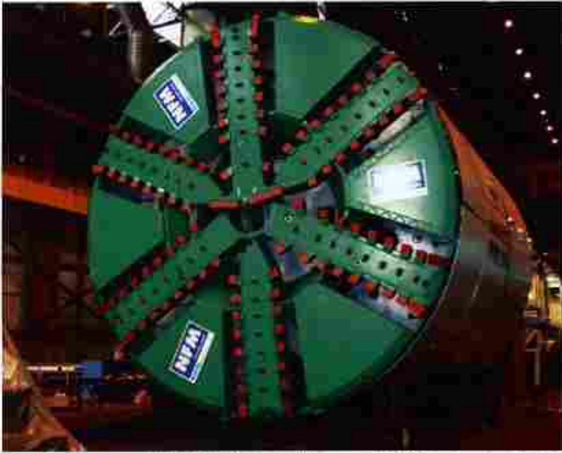
شکل ۲- نمایی یکی از TBM متروی شیراز در کارخانه NFM فرانسه
